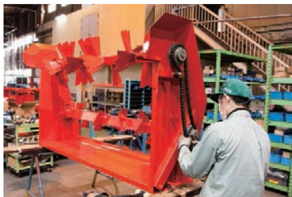
溶接・塗装後の部材にチェーンを組み付ける
