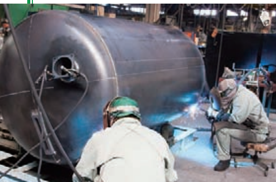
バキュームカーのタンクの溶接作業
