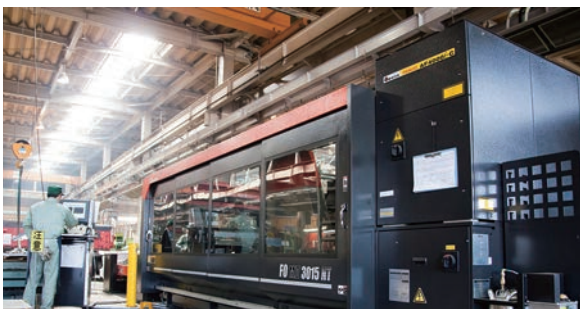
2013年10月に導入したレーザーマシンFO-MII 3015NT(シャトルテーブル付き)。板厚19mmまでの厚板に対応し内製に貢献するとともに、生産性が30%向上した
