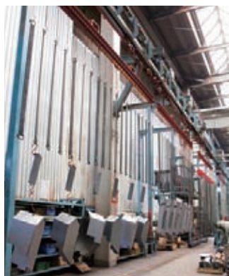
粉体塗装ライン。洗浄・脱脂・塗装・乾燥まではほぼ自動で行う
