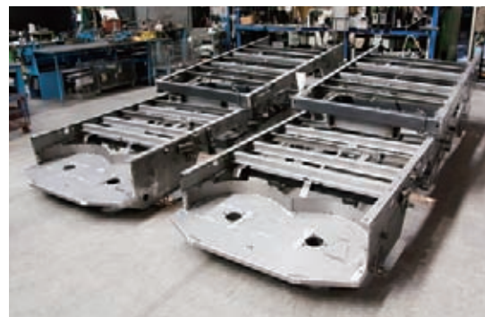
溶接が完了したマニアスプレッダのフレーム
