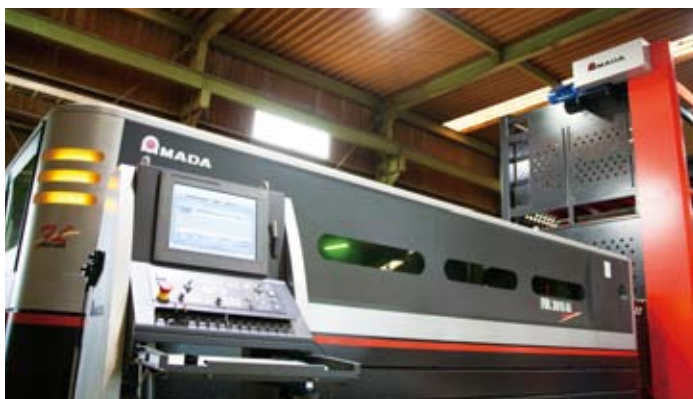
薄板領域でLC-F1NTの2倍の生産性を発揮しているファイバーレーザーマシン FOL-3015AJ
