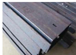
(左)FO-MII RIで位置決め用のタブを加工し、大部分は治具レスで組み立てられる嵌め合い構造にしている
