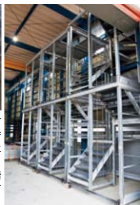
(左)FO-MII RIで位置決め用のタブを加工し、大部分は治具レスで組み立てられる嵌め合い構造にしている
