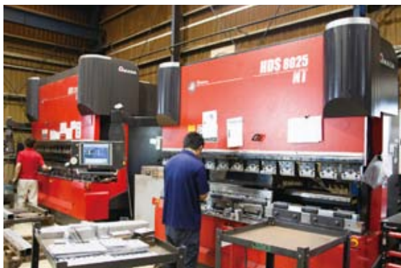
ベンディングマシンHDS-2203NT(奥)やHDS-8025NT(手前)などが並ぶ曲げ工程
