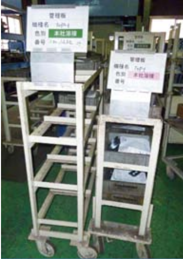
前加工が終了した部材は、前工程の作業者が機種単位に台車へ積載、行き先看板で次工程を指示して配膳する
