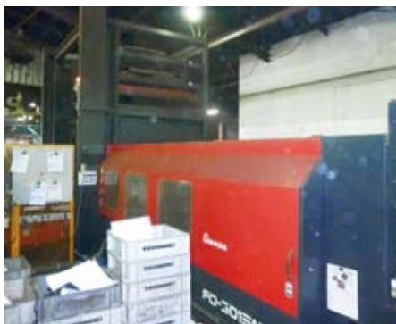
2002年に導入したレーザマシンFO-3015NT (棚付き)
