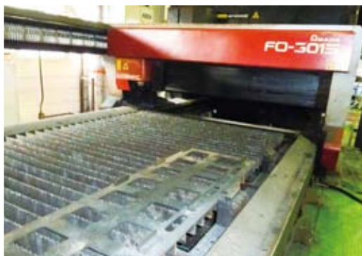
1号機のFO-3015には形鋼の加工ができるように治具をセット
