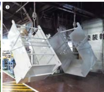
①ベンディングマシンHDS-8025NTによる曲げ加工／②シャフト(軸物)加工を行うNC旋盤／③ポテトハーベスターに装着される部材の塗装工程
