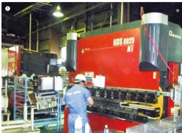
①ベンディングマシンHDS-8025NTによる曲げ加工／②シャフト(軸物)加工を行うNC旋盤／③ポテトハーベスターに装着される部材の塗装工程
