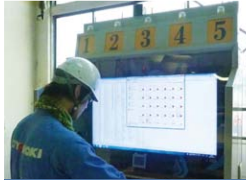
組立工程の端末はアンドンの機能を持ち、工程納期内で組立が終了できそうにない場合にはバトライトが点滅する
