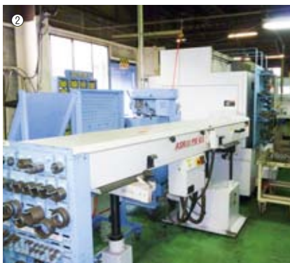
①ベンディングマシンHDS-8025NTによる曲げ加工／②シャフト(軸物)加工を行うNC旋盤／③ポテトハーベスターに装着される部材の塗装工程
