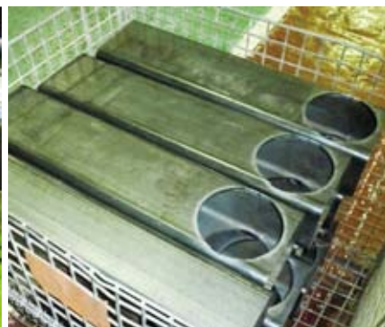
FO-3015で加工した形鋼(角パイプ・肉厚9mm)
