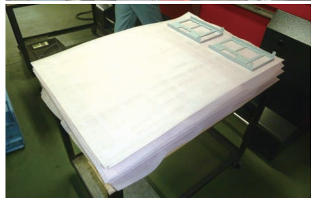
(上)NTベンダーが並ぶ (中央)HDS-8025NTによるステップバンド加工で12曲げを行う (下)サビ・キス防止対策の一環。「青色」の保護材の間にSPCCの製品を載せ、SPCC以外の製品は「ピンク色」の保護材で大切に扱う
