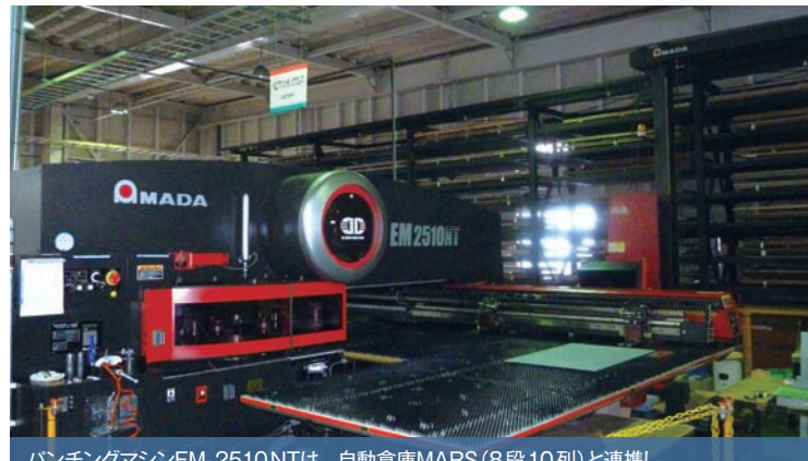
パンチングマシンEM-2510NTは、自動倉庫MARS(8段10列)と連携している
