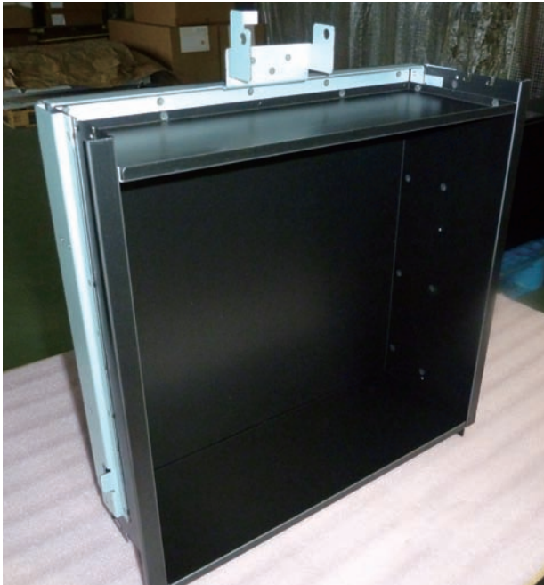
塗装が完了した情報機器のボックスケース
