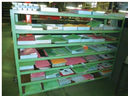
工程間の仕掛品は、得意先別に分けられた作業指示書とセットで中間バッファの棚に格納される
