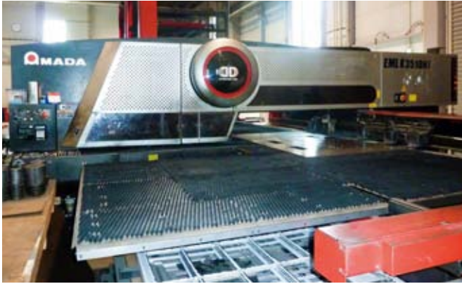
上／パンチ・レーザ複合マシン EMLK-3510NT+ULS- 48M+AS-48RM 左／シート材にネ스팅され、 EMLで加工した製品
