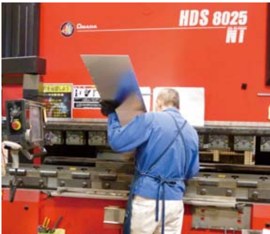
左／ベンディングマシンHDS- 8025NTで鉄道車両部品の 曲げ加工を行う 上／曲げ加工後の鉄道車両部品
