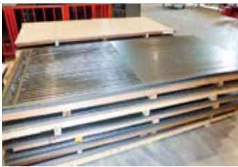
上／パンチ・レーザ複合マシン EMLK-3510NT+ULS- 48M+AS-48RM 左／シート材にネ스팅され、 EMLで加工した製品
