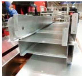
左／ベンディングマシンHDS- 8025NTで鉄道車両部品の 曲げ加工を行う 上／曲げ加工後の鉄道車両部品
