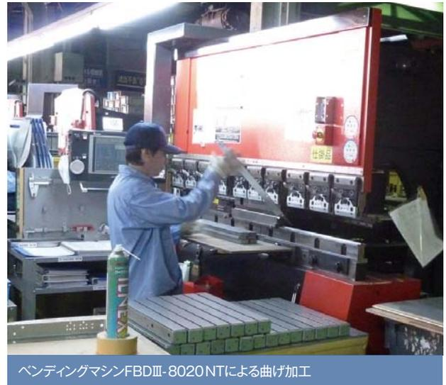
ベンディングマシンFBDIII-8020 NTによる曲げ加工
