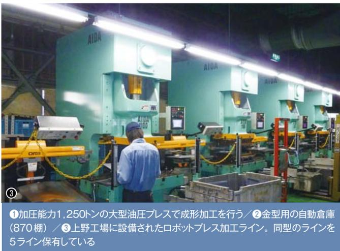
①加圧能力1,250トンの大型油圧プレスで成形加工を行う／②金型用の自動倉庫(870棚)／③上野工場に設備されたロボットプレス加工ライン。同型のラインを5ライン保有している
