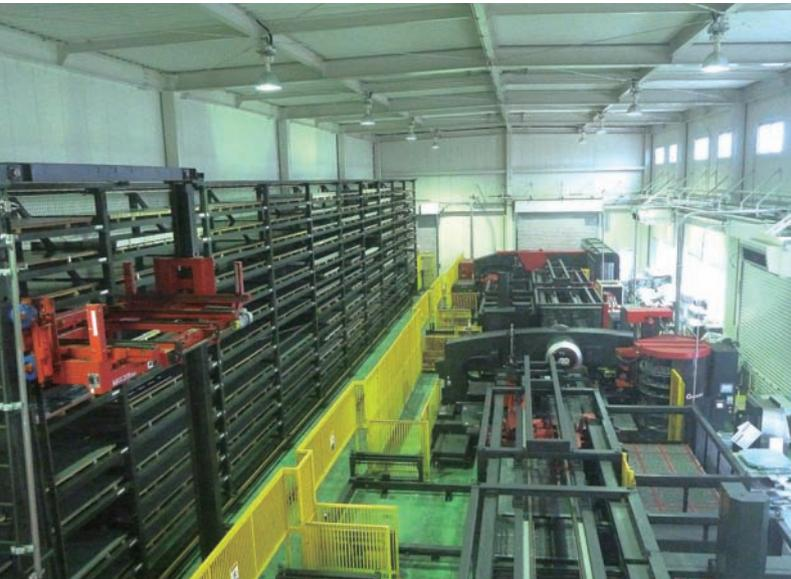
自動倉庫MARS(12段11列)と連動したバンチングマシンEMZ-3510NTP(手前)と、シングルパンチプレスHMX-3510NT(奥)。24時間連続稼働にも対応
