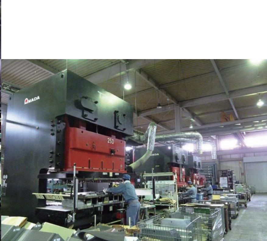
2012年に導入したダブルクランクプレス TPW-250などによるトランスファー加工
