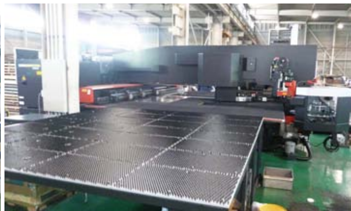
ACIESには補助テーブルを設置し、長尺製品の加工に対応できるようにしている
