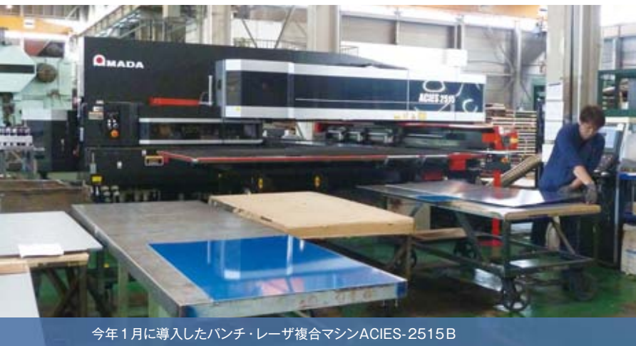
ACIESには補助テーブルを設置し、長尺製品の加工に対応できるようにしている
