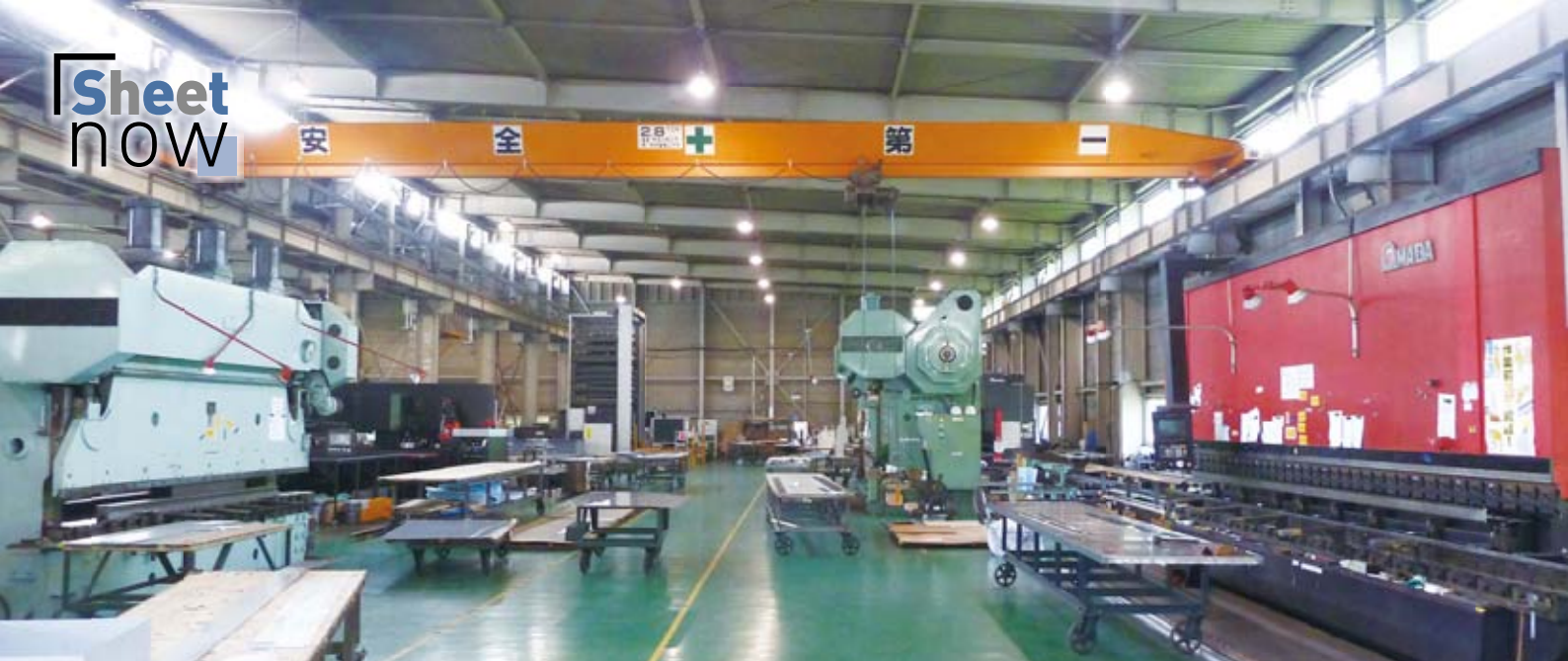
リョーユウ工業株式会社の工場内。8m対応のベンディングマシンやシャーリングマシンが並ぶ
