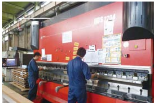
ベンディングマシンHDS-2204NTによる曲げ加工。長尺製品のため2人作業で対応
