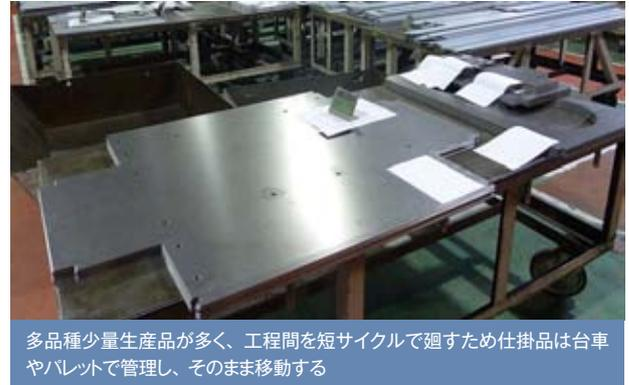
多品種少量生産品が多く、工程間を短サイクルで廻すため仕掛品は台車やパレットで管理し、そのまま移動する
