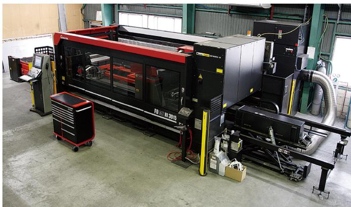
2010年11月に導入した平板・パイプ・形鋼の加工に対応するレーザーマシンFO-MII RI 3015NT (シャトルテーブル付き)
