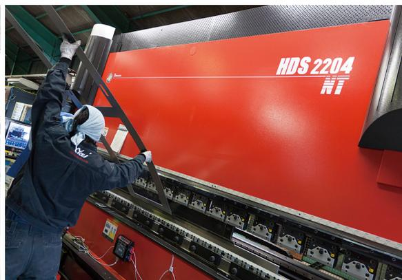
ベンディングマシンHDS-2204NTによる曲げ加工。Bi-J(曲げ角度センサー)付き
