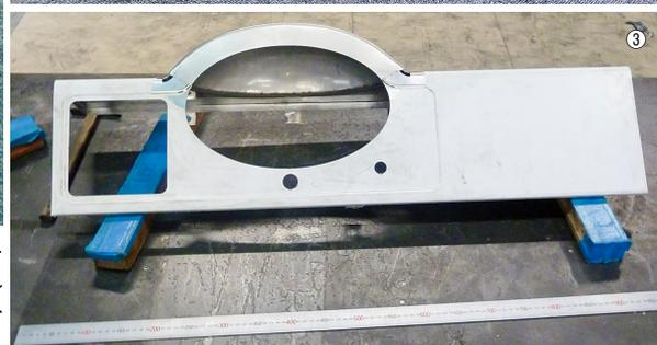
①ラバトリーシンク(SUS304・板厚1.5mm)。5部品で構成され、「ファンボロー国際航空ショー」で注目を浴びた／②シンクの裏側には、積層金型で成形加工されたシンクカバーが取り付けられており、2重構造になっている／③製作中のリブート品。板厚を0.8mmに変更して軽量化を図っている
