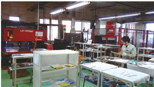
レーザマシンLC-1212a(左)と、ペンディングロボットシステムEG-6013AR+EGROBOT(右)
