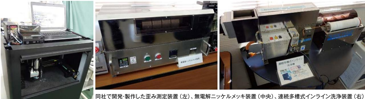
同社で開発・製作した歪み測定装置（左）、無電解ニッケルメッキ装置（中央）、連続多槽式インライン洗浄装置（右）
