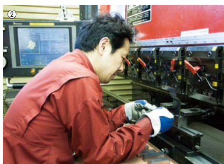
①バンチングマシンEM-255NT / ②ベンディングマシンFBDⅢ-8020NTによる曲げ加工 / ③3次元CADを活用し、企画・構想、設計・開発の段階から対応可能
