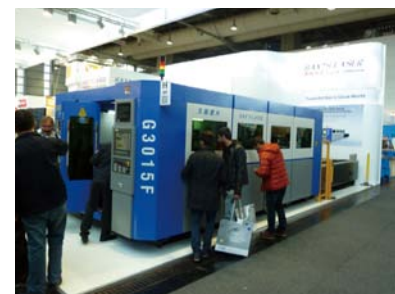
中国の大族激光(Han's Laser)はIPG製発振器(4kW)を搭載したファイバーレーザーマシンG3015Fを出展した
