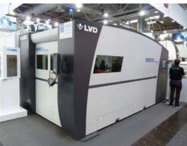
LVDは2kWから6kWまでの発振器を搭載できるファイバーレーザーマシンELECTRAシリーズFL-3015を出展
