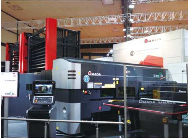
テーブルキャビネット方式でレーザーの反射光を遮蔽し、安全性と操作性をPRしたアマダのファイバーレーザー複合マシンLC-2515C1AJ
