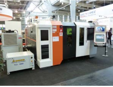
トルコのErmaksanはIPG製発振器(4kW)を搭載したファイバーレーザーマシンを出展
