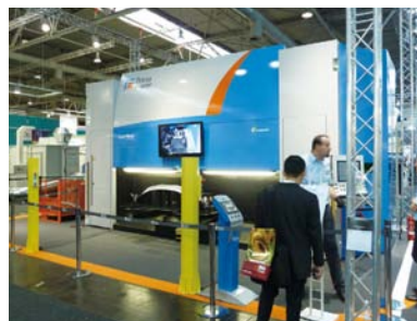
Prima Powerは4kWのファイバーレーザー発振器を搭載した3次元5軸レーザーマシンを発表。ホット材のトリム加工に多用されている
