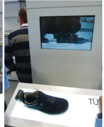
Trumpfは曲げ作業の自動化の一環として、作業者が履く作業靴にセンサーを仕込むことで、コントロールパネルに触らなくても曲げ作業をナビゲーションするシステムを発表 (左) / センサーを仕込んだ作業靴 (右)
