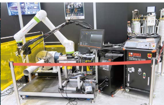
日酸TANAKAは、3kWハンディファイバーレーザ溶接機「FLM-3000W」の協働ロボットシステムを参考出展した
