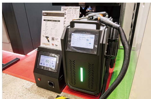
プレスは、空冷式2000Wのハンディファイバーレーザー溶接機(写真)と3D溶接定盤を出展した
