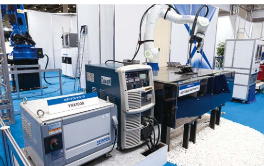
安川電機は、熟練工の手技を再現するAIアーク溶接ロボットを参考出展した
