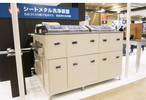
エステーリンクは、ワークに付着した油分や異物を除去する「シートメタル洗浄装置」を出展した
