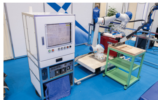
安川電機は、人協働ロボットとエンコーダーを搭載した台車で長尺ワークの溶接が行えるソリューションも提案した
