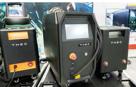
MAXPHOTONICS JAPANは、空冷式のハンディファイバーレーザ溶接機「THEO MA-1シリーズ」を出展した
