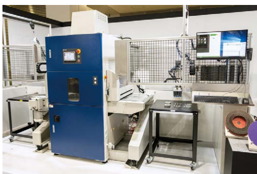
エステーリンクは、バリ取り機に装着するオプション「自動搬入搬出装置」を出展した
