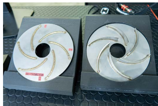
FLW-6000 ENSISeで溶接を行った「インペラ」（羽根車）の加工サンプル
