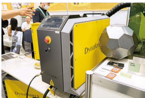
中国・Dynalasers Technologyは、空冷式1800Wのハンディファイバーレーザ溶接機「M70」を出展した
