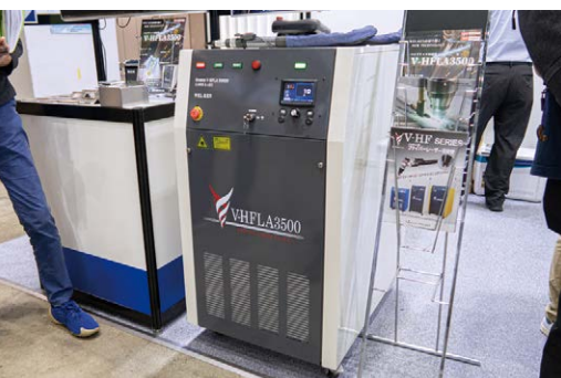
WEL-KENは、レーザ溶接とアーク溶接を組み合わせたハイブリッド溶接機「VHFLA3500」を出展した
