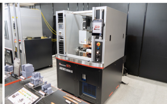
アマダが初披露した3機種。左から、インテリジェント・ブルーレーザ溶接システム「ALCIS-0403e」、パルスファイバーレーザ溶接システム「MF-P6000A+MS-LW1300」、高効率抵抗溶接システム「AREWS 0800 IS」
