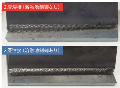
溶融池の状態を観察しながらトーチの動作を自動調整し、最適なビード幅で溶接を行った加工サンプル(下)
