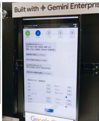
ファナックは「AI溶接エージェント」によるアーク溶接の実演を行った(左)。タブレットTPの内蔵カメラで部品の紙図面を撮影すると(中央)、Googleの生成AI「Gemini Enterprise」が図面の情報を読み取ってプログラムを自動生成する(右)
