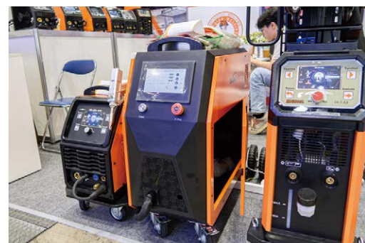
中国・Foshan Sanqiao Welding Industrialは空冷式1200Wのハンディファイバーレーザ溶接機を出展
