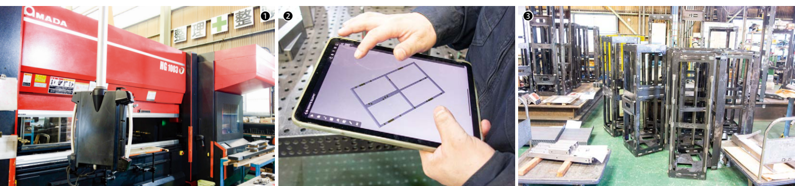
①自動金型交換装置付きベンディングマシンHG-1003ATC／②現場ではタブレット端末で製品モデルの確認ができる／③データセンター向け装置のフレーム架台
