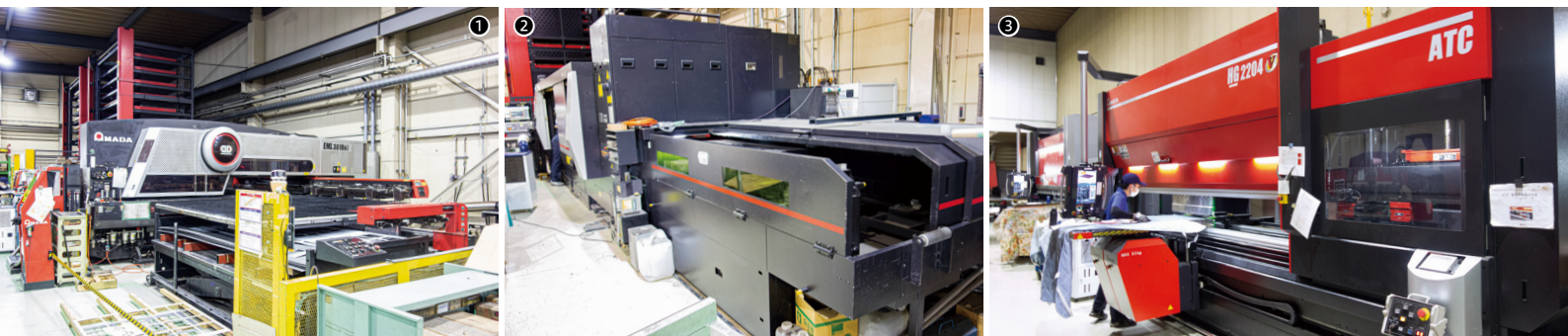
①パンチ・レーザ複合マシンEML-3610NT+AS-510RM+ULS-510RM / ②平板・パイプ兼用ファイバーレーザマシンENSIS-3015RI (3kW)+AS-3015G+STRI-3015 / ③自動金型交換装置付きベンディングマシンHG-2204ATCによる曲げ加工
