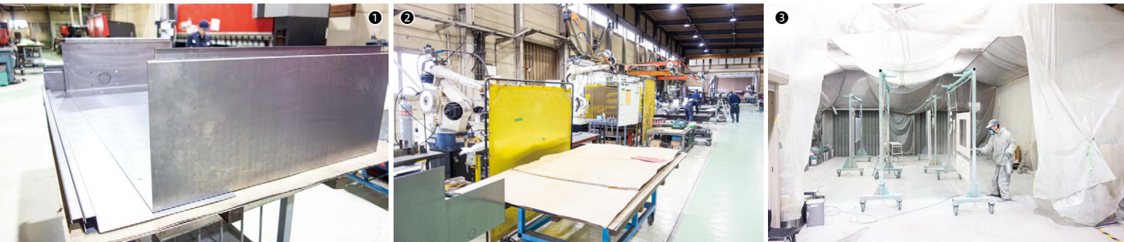
①曲げ加工された筐体製品／②4台の溶接ロボットも活躍する溶接工程／③塗装ブース
