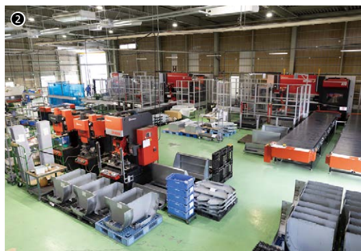
①2023年に開設したブランク専用工場。工場建屋の面積は約1.5倍に広がった／②奥に3台のベンディングロボットシステムが並ぶ。手前はプレス工程／③ファイバーレーザー溶接システム FLW-3000ENSIS（左）。溶接治具（右）は同じものを Sander Robo でも使用している
