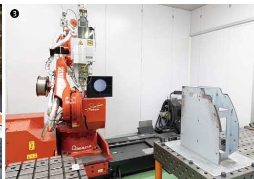
①2023年に開設したブランク専用工場。工場建屋の面積は約1.5倍に広がった／②奥に3台のベンディングロボットシステムが並ぶ。手前はプレス工程／③ファイバーレーザー溶接システム FLW-3000ENSIS（左）。溶接治具（右）は同じものを Sander Robo でも使用している
