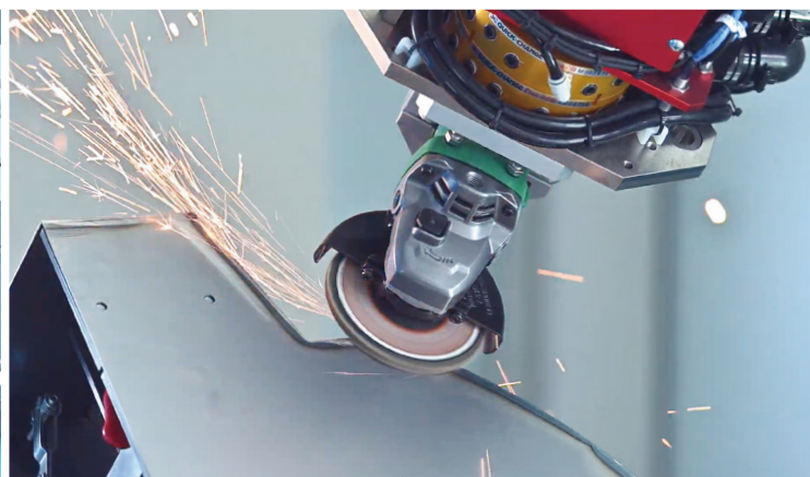
自社開発のサンディング自動化システム「Sander Robo」の3号機（左）と、装置カバーのサンディング作業（右）
