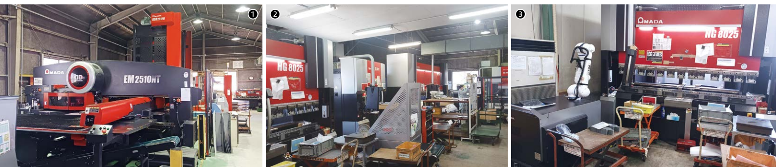
①パンチングマシンEM-2510NT+ASR-2512N／②曲げ工程。吉田社長は「生産力を上げるためにはまずベンディングマシンを入れて全体の様子を見る」と語っており、ベンディングマシンを積極的に採用している／③ベンディングマシンHG-8025（右）と、今年新たに導入したベンディングマシン用協働ロボットCR-010B
