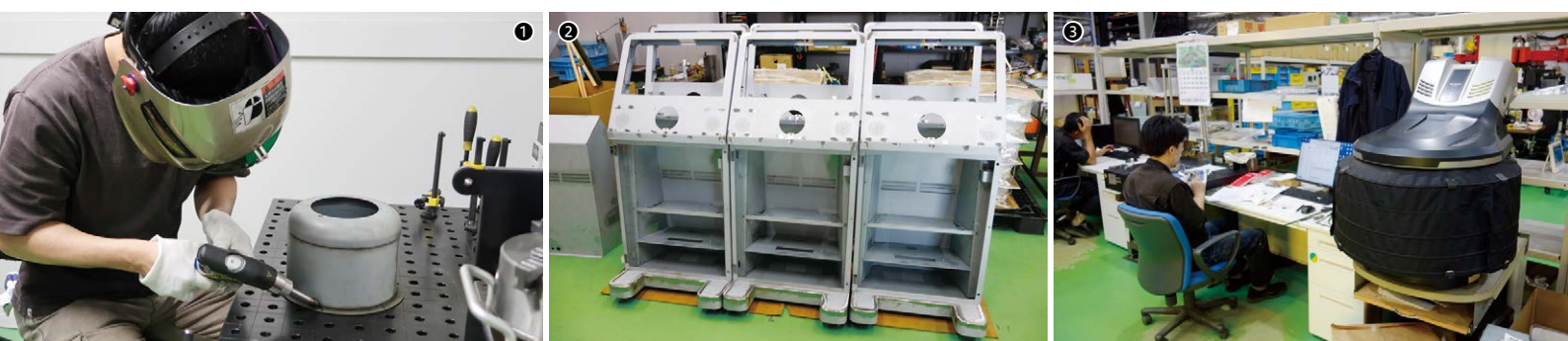
①2024年5月に導入したハンディファイバーレーザ溶接機FLW-1500MTによる物流機器部品の溶接作業／②デジタルサイネージ関連はTIG溶接で溶接する／③品質管理工程では、3次元測定機などを使った品質検査が行われている
