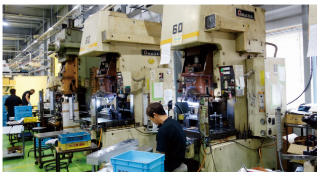
創業当時から行っているプレス加工は金型の種類も豊富。規模は縮小したものの現在もプレスマシン6台が稼働している
