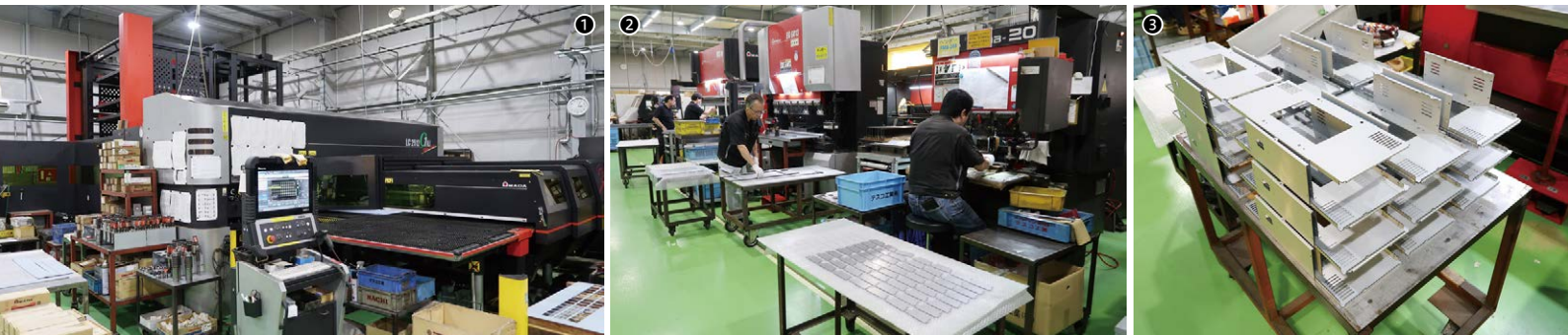
①ファイバーレーザー複合マシンLC-2512C1A)+ASR-2512NTK。ブランク工程ではLC-C1A)とLC-2012C1NT、AC-255NTの3台が稼働する／②ベンディングマシンEG-6013（中央）などが並ぶ曲げ工程／③曲げ加工済みの産業機器部品
