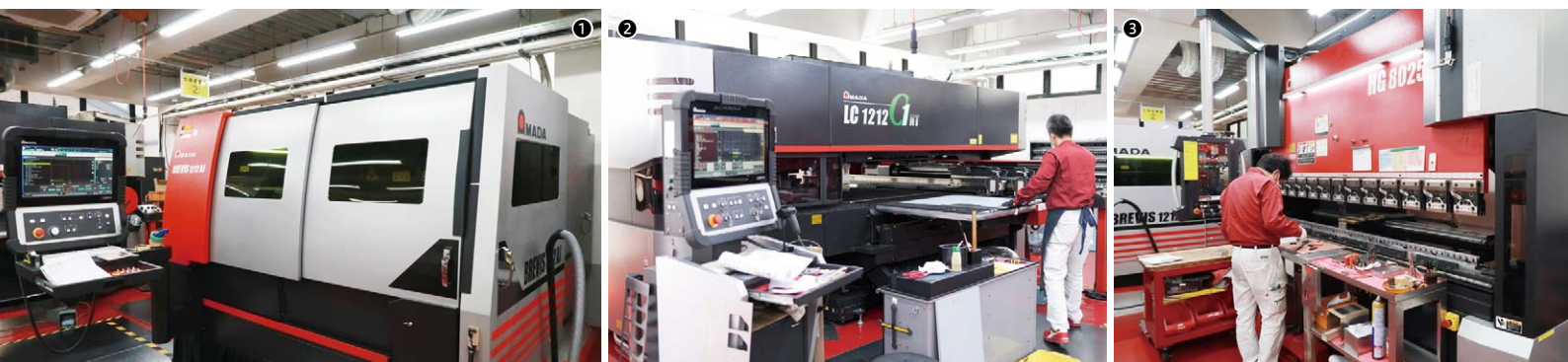
①ファイバーレーザーマシンBREVIS-1212AJ／②パンチ・レーザー複合マシンLC-1212 C1NTによるブランク加工／③ベンディングマシンHG-8025による曲げ加工
