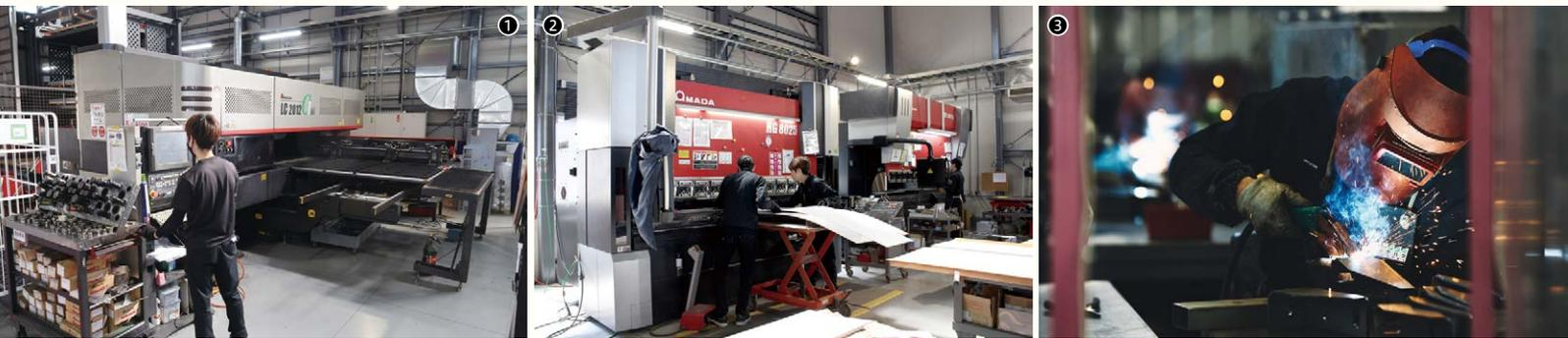
①パンチ・レーザ複合マシンLC-2012C1NT+AS-2512C1。2024年4月に入社した山崎大地さんがオペレータを務める／②ペンディングマシンHG-8025（手前）、HD-1303NT（奥）が並ぶ曲げ工程／③ベテラン社員による溶接加工。同社の製品には「ベテランによる高度な技術が欠かせない」（かおり社長）という
