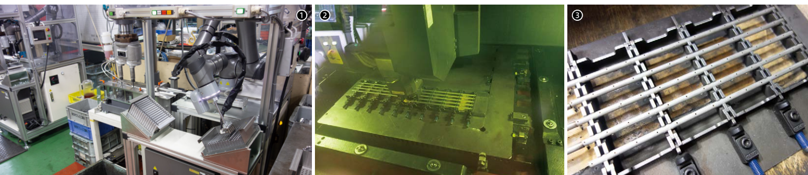
①協働ロボットを活用してM5～M8の7品目のタップ作業を自動化／②ファイバーレーザーマシンBREVIS-1212AJでステンレス鋼管（φ6mm）にφ1mmの穴あけ加工を行う／③BREVIS-AJによる穴あけ加工が完了したステンレス鋼管
