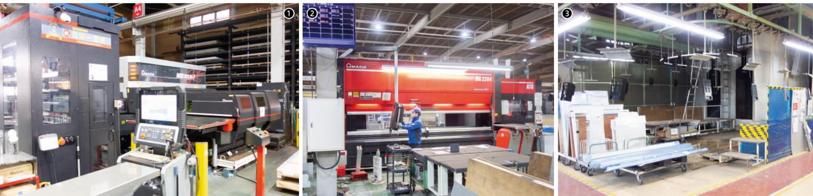
①2021年にTK（テイクアウトローダー）付きで導入したファイバーレーザー複合マシンACIES-2512T-AJ／②自動金型交換装置付きベンディングマシンHG-2204ATC／③塗装工程
