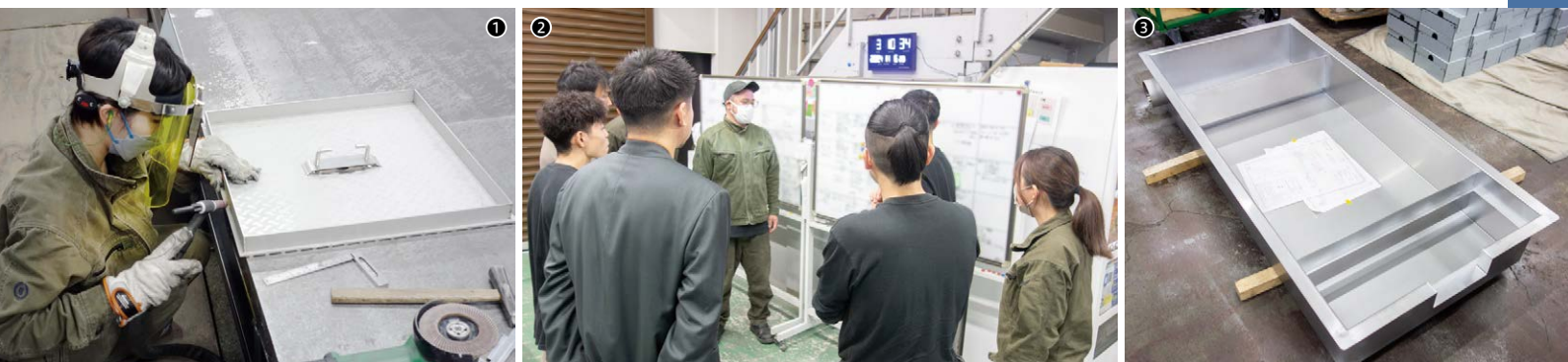
①2024年4月に入社した22歳の女性社員もTIG溶接を行う／②工程進捗を確認するために、各工程のリーダーが1日2回以上集まって開催される工程会議／③下水に油脂分が直接流れ込んだりするのを阻止するグリーストラップ
