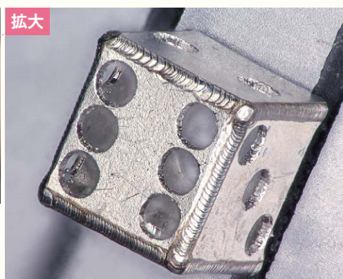
微細溶接で組み上げた「1mm角サイコロ」(SUS304・板厚0.05mm)。非常に技術力のいる製品だが、同社にはこれをつくれる作業者が複数いる
