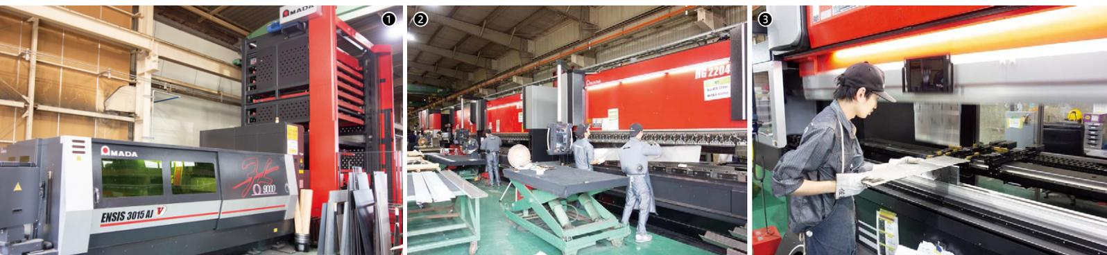
①ファイバーレーザーマシン ENSIS-3015AJ+ASFH-3015FMⅡ / ②長さ4mまでの長尺曲げに対応するHG-2204（手前）などのベンディングマシンが並ぶ曲げ工程 / ③EGB-ATCeに設置されたタブレットHMIが曲げ作業をサポートする
