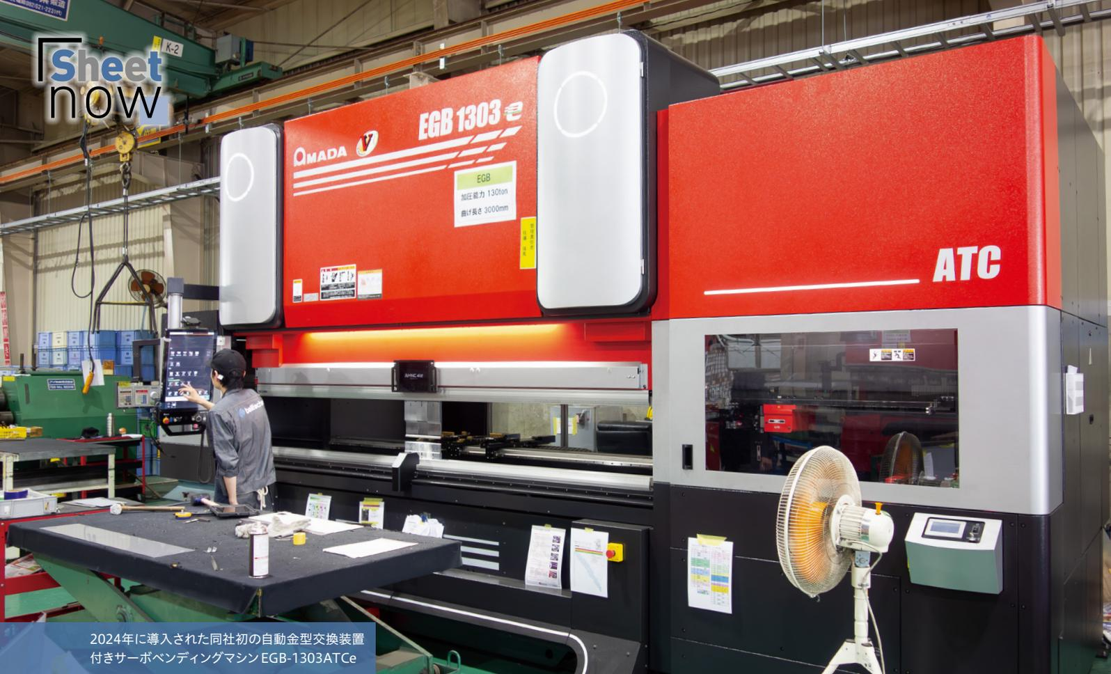
2024年に導入された同社初の自動金型交換装置
