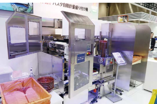
不二精機は麺をほぐして分割し、容器の上に盛り付ける「パスタ供給装置（DHP）」を出展した
