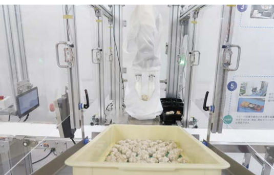
フィンガービジョンは多品種・不定形で壊れやすい食材に対応する触覚センサー付きロボットハンドを出展した
