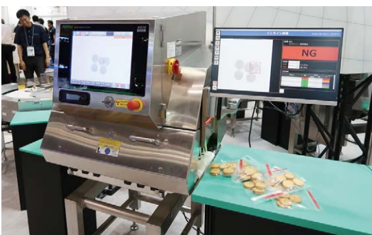
アンリツは「外付けAI」に対応したX線検査機を出展。独立したAI判定機能で検査能力をアップできる
