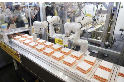
ファナックはエポキシ塗装と食品用グリースを採用した食品仕様の協働ロボット「CRX-5iA」を出展
