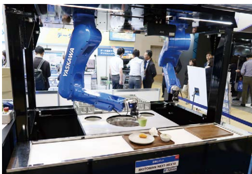
安川電機は自律ロボット「MOTOMAN NEXT」を出展。みずから判断・計画し、指示された作業を完結させる
