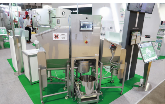
ツカサ工業は粉体食品原料の多品種少量配合が可能なコンパクト自動計量装置を出展した
