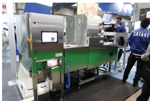
サタケはベルト式光選別機「ベルトウーザスペクトラ」により形状・色のバラツキが大きいピスタチオの検査・選別を実演した
