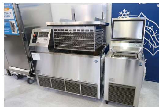
ホシザキは液体急速凍結機を参考出品。マイナス35度のエタノールで急速凍結し、高品質な冷凍を行う
