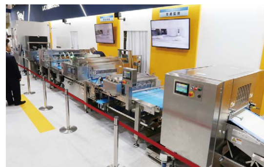
レオン自動機はペストリーの折り込み作業、生地延展作業、成形作業を自動化する「HMペストリーライン」を出展
