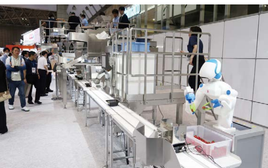
大和製衡は4台の自動計量機を並べたパスタの計量・トッピング・検査・包装の自動化ラインを出展した
