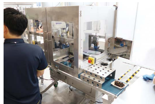
コネクテッドロボティクスは、惣菜盛付ロボット「Delibot」によるひじきの煮物の盛り付けを実演
