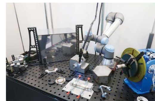
ファブエースはユニバーサルロボットの協働ロボットによるTIG溶接支援協働ロボットシステムを提案
