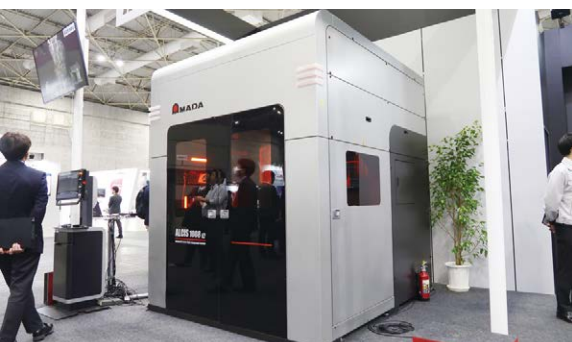
アマダの3次元レーザ統合システム「ALCIS-1008e」。EVモーター用平角銅線のヘアピン溶接を実演した
