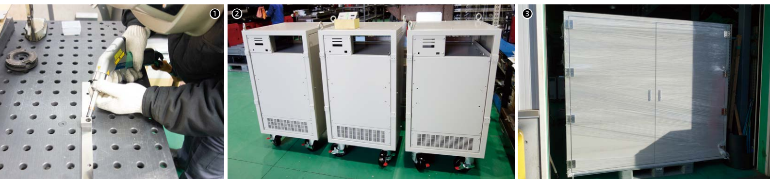
①ハンディファイバーレーザー溶接機FLW-1500MTによる溶接作業／②試験機の筐体／③試験機のための防煙カバーボックス
