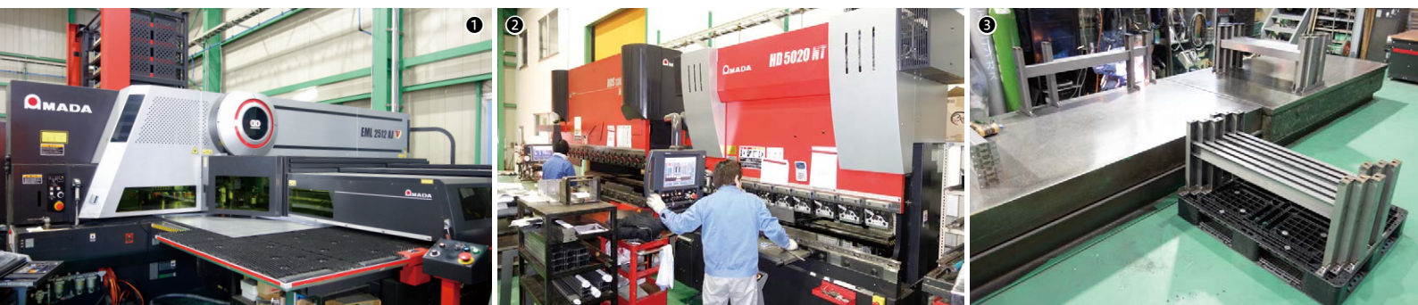
①ファイバーレーザー複合マシンEML-2512AJ+ASR-2512N / ②ベンディングマシンHDS-1303NT (奥)、HD-5020NT (手前) が並ぶ曲げ工程 / ③溶接エリアでは架台の溶接作業を行っていた
