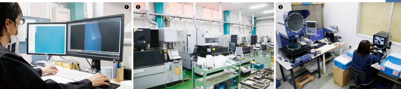
① 2次元CAD・3次元CADを設備し、設計から対応する／②金型加工エリアにはワイヤ放電加工機5台(写真)、マシニングセンタ2台を設備。プレス機の大型化にもない金型加工設備も増強した／③検査室。3次元形状測定器、画像寸法測定器、測定投影機などを複数台設備し、品質管理を徹底している
