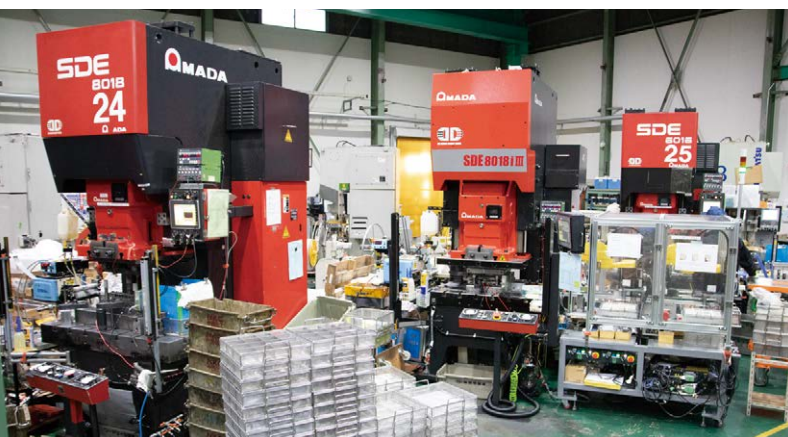
2005年以降に導入した60~80トンのサーボプレス。中央が2021年に増設したSDE-8018iⅢ
