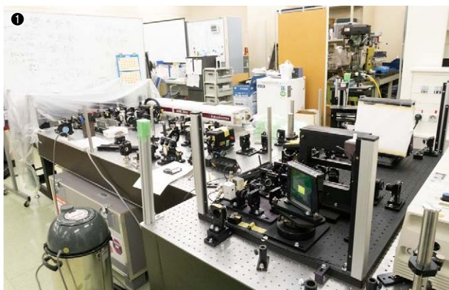
① 2023年11月に導入したフェムト秒レーザー。研究室には2台のフェムト秒レーザーが設置されている／② 3台あるYAGレーザーのうちの1台。精度を一定に保つため温度を管理、湿気対策なども行っている
