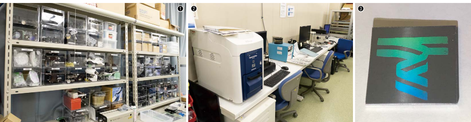
①工学系に組み込むステージやミラーなどがいつでも使えるように用途ごとに整理されている／②卓上電子顕微鏡、コーター装置、データ集積用サーバーなどが並び／③材料表面にナノ微細構造を形成した加工サンプル
