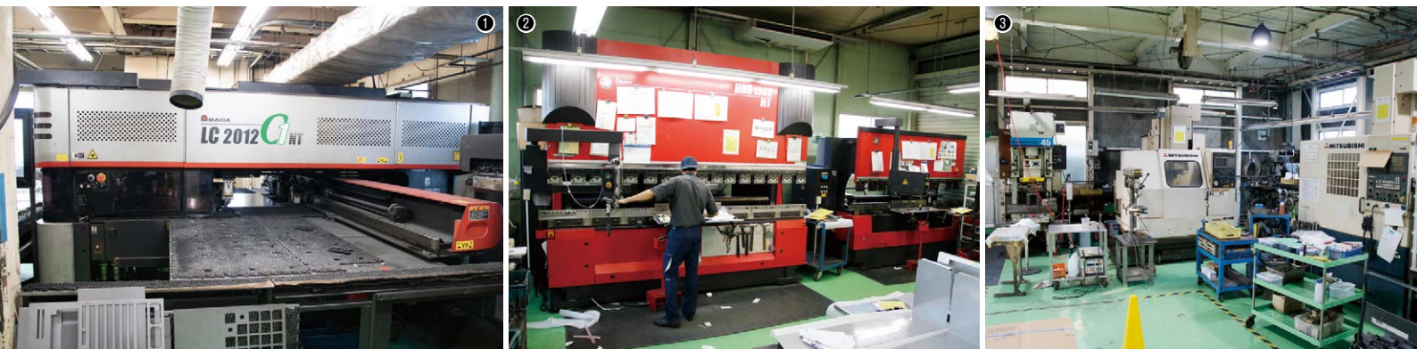
①バンチ・レーザ複合マシンLC-2012C1NT / ②曲げ工程。HDS-1303NTにより長さ3mまでの曲げ加工に対応する / ③機械加工エリア。マシニングセンターや小型プレス機を設備し、板金加工との複合加工にも対応する
