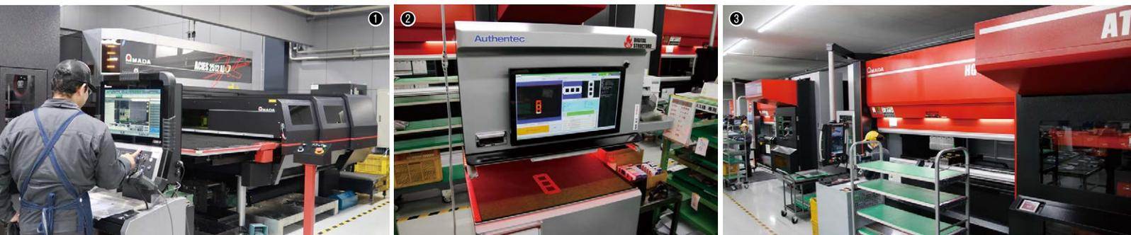
①ファイバーレーザ複合マシンACIES-2512T-AJ / ②加工知識がない人や図面が読めない人でも仕分け作業ができる製品識別機AuDeBu Scan / ③2台並んだ自動金型交換装置付きベンディングマシンHG-1003ATC。金型交換の負担がないため経験の浅い作業者でも使いやすい
