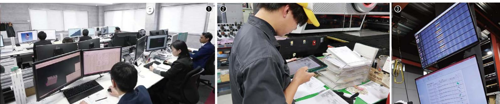
①CADルーム。ほとんどのメンバーがSheetWorks、SolidWorksによる3次元設計を行う／②現場のスタッフの多くがモバイル端末を持ち、進捗情報の入力などに使用する／③現場の各工程では、大型モニターにジョブリストが表示され、その日に対応する仕事を確認できる
