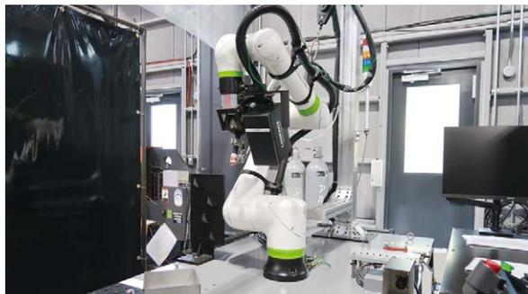
「加工知識がない人でも簡単に溶接できるシステム」の実現を目指し、開発中の「AI搭載型自動溶接システム」
