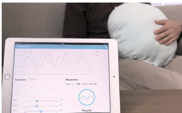
抱きかかえるだけで呼吸が整うロボットクッション「Relaxushion」。設計の工夫でスタンドアローンでの動作、1kg以下の軽量化（機構部）を達成
