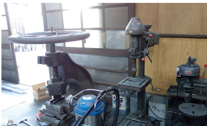
同社の職人たちが使用する手回しのプレス機やボール盤が並ぶ工場内
