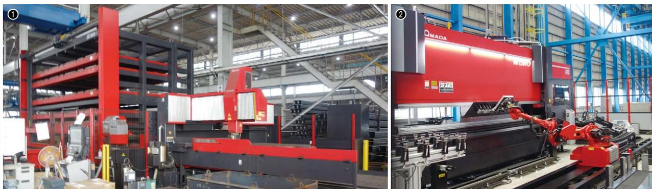
①レーザーマシンLC-6030Ⅲと多段式パレットチェンジャー AS-61020PC / ②2021年12月に導入されたペンディングロボットシステムHG-2204ARm+HGROBOT-80による曲げ加工。製品を集積するためのパレットリボルバーも設置されている
