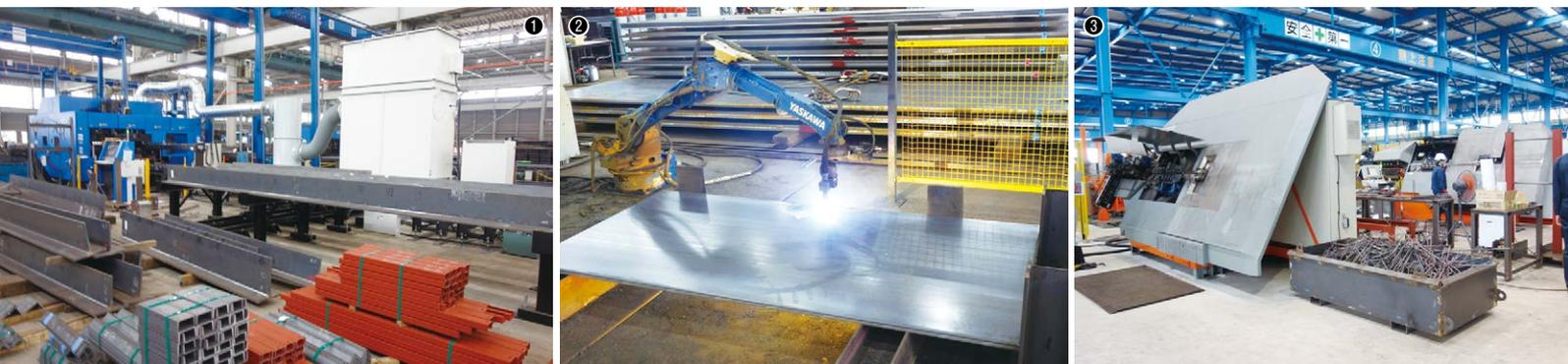
① 2021年12月に導入したコラム加工ラインは、同社初のコラム加工設備／②安川電機と共同開発した数鉄板の機械加工とプラズマ切断を同所加工できる複合加工用ロボットによる加工／③イタリア・シュネル社の全自動鉄筋加工機
