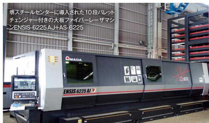
堺スチールセンターに導入された10段バレットチェンジャー付きの大板ファイバーレーザーマシンENSIS-6225AJ+AS-6225
