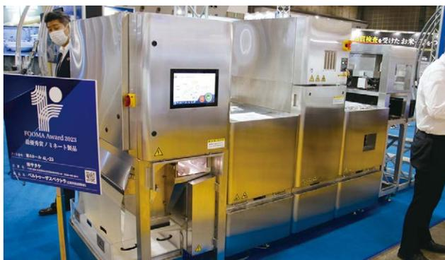
「第2回FOOMAアワード2023」の「最優秀賞」に選ばれたサタケのベルト式光選別機「ベルトウーザスペクトラ」。内観検査・外観検査・成分検査に1台で対応する
