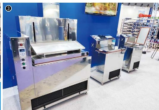
①前川製作所は連続式急速凍結装置「Thermo-Jack Freezer」を出展。凍結（冷却）時間を1/2～2/3に短縮する／②フクシマガリレイは「トンネルフリーザー・省人化ロボットライン」を出展した／③米田工機は液体急速凍結機「リ・ジョイスフリーザー」を出展。マイナス35℃のアルコールに食品を浸漬して凍結させる
