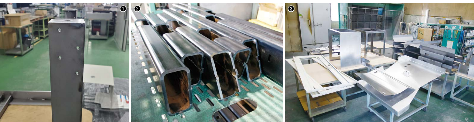
①半導体製造装置向けフレーム。曲げによる一体構造から溶接構造へと工法転換を行うことで全体の工数を25%削減できた／②装置フレームに使用する角パイプ。レーザーマシンで突起や切り欠きを加工し、はめ合い構造にすることで溶接組立工程を効率化している／③塗装待ちの製品。フレームやアルミのカバーもある
