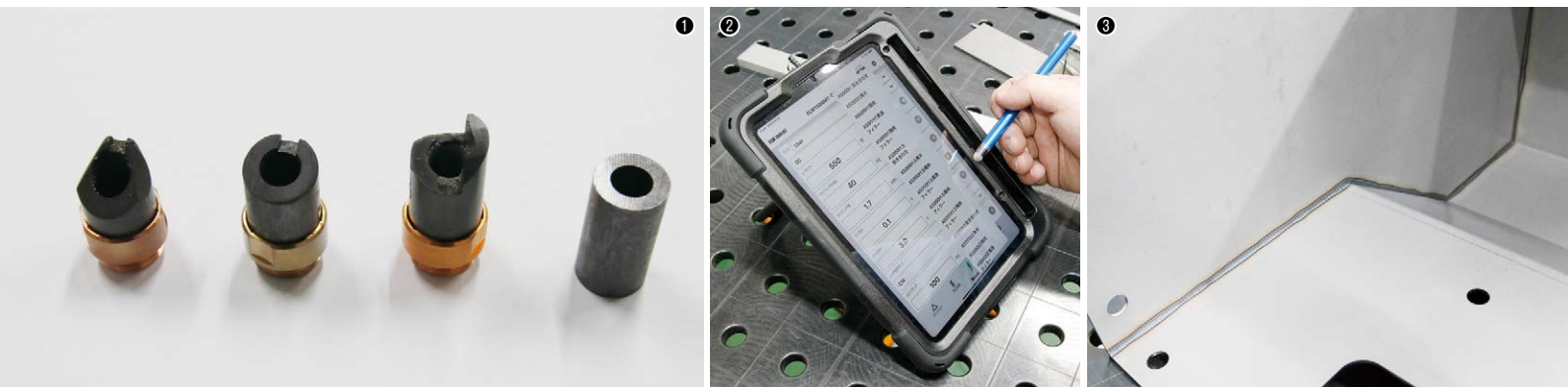
①FLW-1500MTのカーボンノズル。右端は標準品で、左の3つはヤスリで自作したもの／②iOS端末の専用アプリのメニューから、溶接条件（材質・板厚・溶接方法など）を手軽に設定できる／③溶接が完了した工作機械カバーの裏側。FLW-1500MT導入後はコーキング作業が不要になり、全体の工数を20%削減できた
