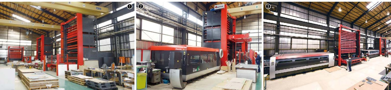
①浦安工場に設備された4kWファイバーレーザーマシンと9kWファイバーレーザーマシンが中板の高速加工に対応する／②レーザーマシンLC-3015F1NT(6kW)+AS-3015F1／③FLC-AJ(9kW・手前)、FOL-AJ(4kW・奥)と2台のファイバーレーザーマシンが並んでいる
