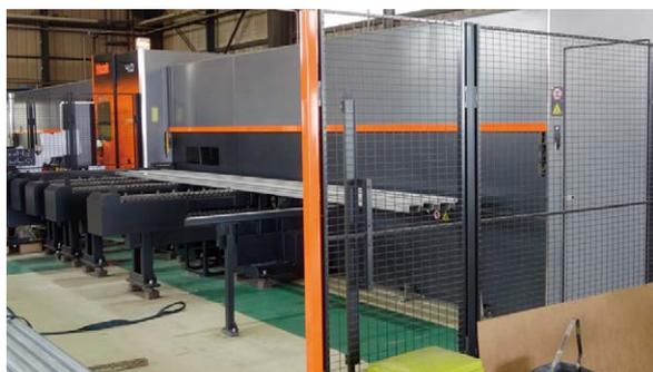
条鋼(パイプ)の加工に対応するDDL(ダイレクトダイオードレーザー)を活用したパイプレーザーマシン
