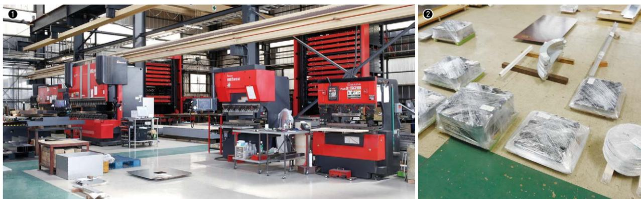
①ベンディングマシンHDS-2203NTなどが並ぶ曲げ工程／②加工後に梱包され、出荷を待つ製品。月間2万2,000件のオーダーに対応している
