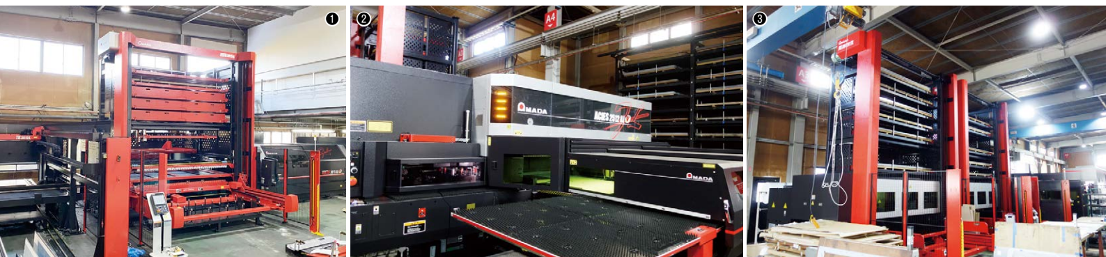
①ファイバーレーザーマシンVENTIS-3015 AJ+ASFH-3015 G+TK-3015 L / ②ファイバーレーザー複合マシンACIES-2512 T-AJ+AS-2512 NTK+ULS-2512 NTK / ③ACIES-AJにはピッキング仕分け+自動識別機能が付いており、製品のキズ防止のため、プラスチック段ボールを挟んで集積することもできる
