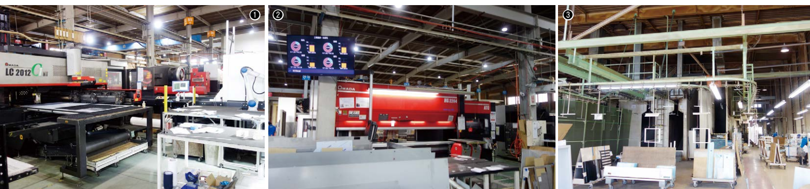
①パンチ・レーザ複合マシンLC-2012C1NT(手前)やパンチングマシンEM-2510NT(奥)が並ぶ／②自動金型交換装置付きベンディングマシンHG-2204 ATC。手前には大型モニターが設置され、工場内のどこからでも工程進捗や生産性が見られるようになっている／③塗装工場
