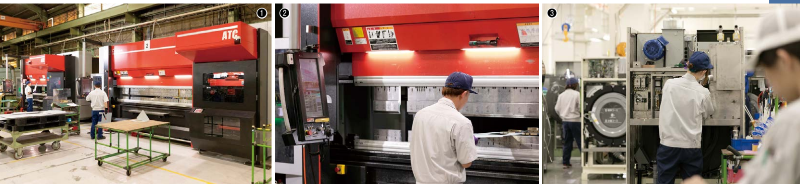
①HG-1003ATCの2号機目、3号機目。それぞれ月間7万ショット以上の曲げ加工を行う／②HG-ATCではステップベンド加工で多工程連続曲げを行う／③洗濯乾燥機の組立ライン
