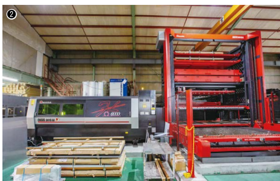
①VPSS 3i BLANKによるネスティングで製品を保持するバキュームパッドの位置をシミュレーションする／②2020年に導入したファイバーレーザーマシンENSIS-3015AJ+ASFH-3015G+TK-3015L／③多数個取りした製品を仕分け集積するテイクアウトローダー TK-3015L
