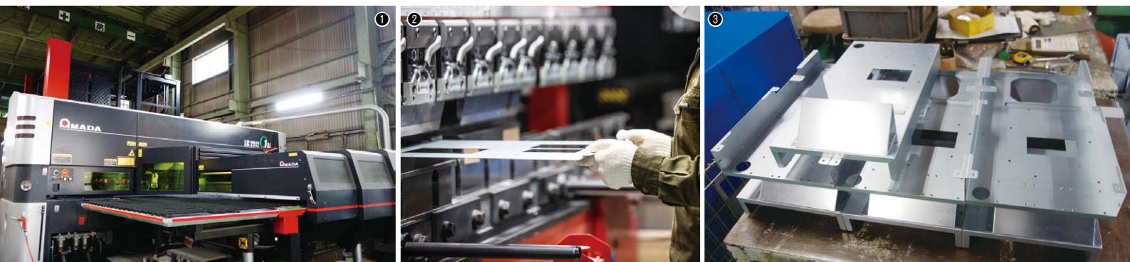
① 2018年に導入したファイバーレーザー複合マシンLC-2512C1AJ+ASR-2512NTK / ②ベンディングマシンHDS-1303NTによる曲げ加工 / ③曲げ加工が完了した製品
