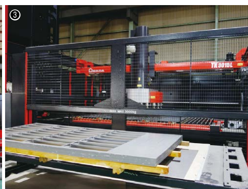
①VPSS 3i BLANKによるネスティングで製品を保持するバキュームパッドの位置をシミュレーションする／②2020年に導入したファイバーレーザーマシンENSIS-3015AJ+ASFH-3015G+TK-3015L／③多数個取りした製品を仕分け集積するテイクアウトローダー TK-3015L
