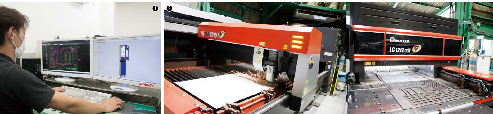
①AutoCAD LTで作成した三面図(左)と3次元ソリッド板金CAD SheetWorksで作成した3次元モデル(右) / ②2020年2月に同時に導入した2台のレーザーマシン、FO-MII 3015NT(左)とLC-1212αVNT(右)
