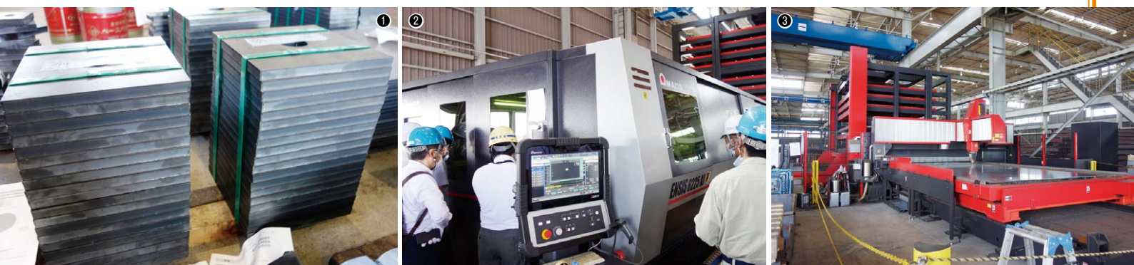
①ENSIS-AJで加工したSM材・板厚16mmの製品／②7月17日に行われたユーザー見学会の様子。参加者たちは熱心にENSIS-AJの加工の様子を見学していた ③レーザーマシンLC-60300Ⅲと多段式パレットチェンジャー AS-61020PC
