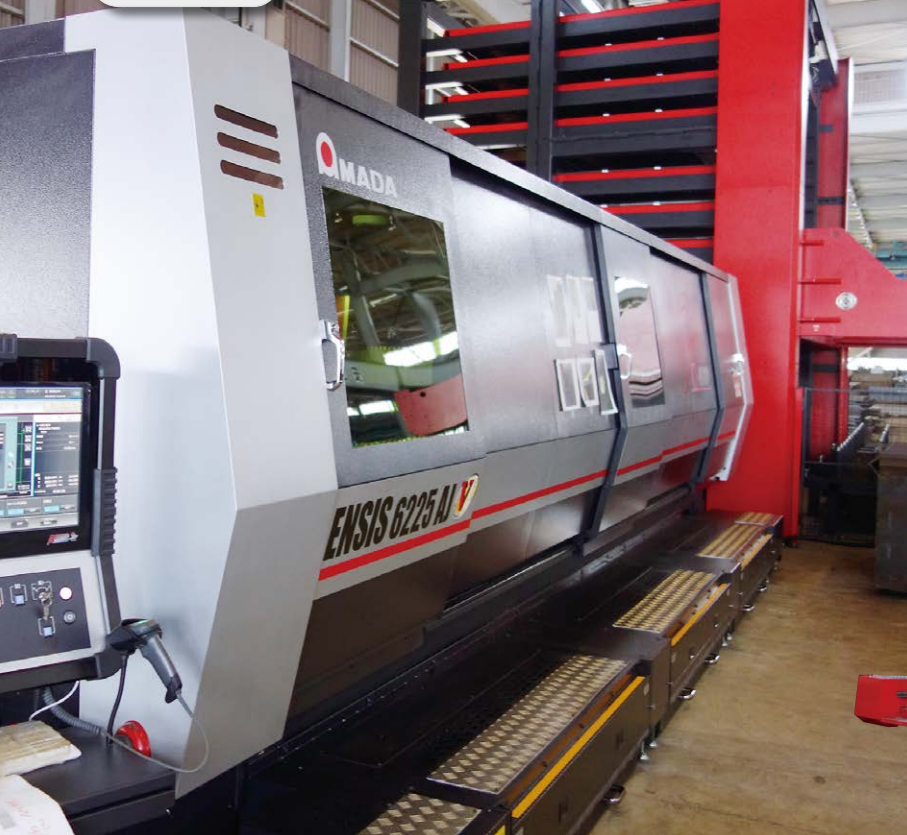
「堺スチールセンター」に導入された10段の多段ストッカーAS-6225(右)付きの大板ファイバーレーザーマシンENSIS-6225AJ+AS-6225(左)
