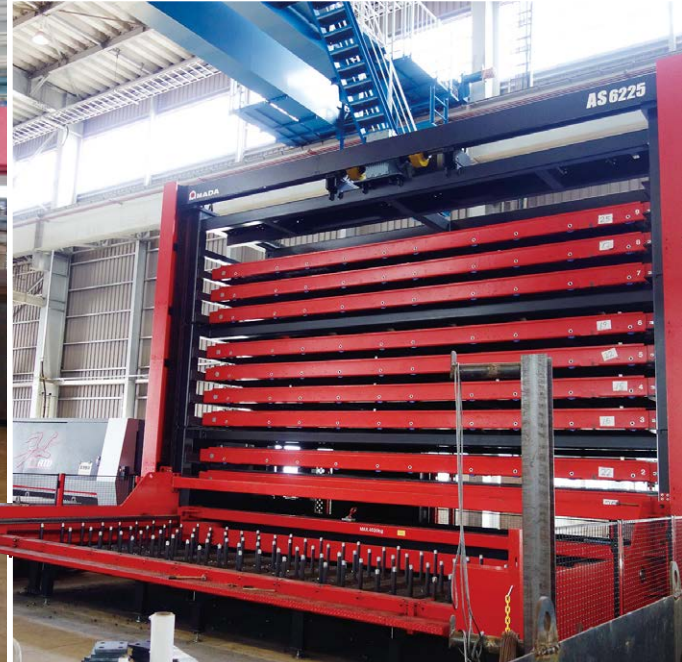
「堺スチールセンター」に導入された10段の多段ストッカーAS-6225(右)付きの大板ファイバーレーザーマシンENSIS-6225AJ+AS-6225(左)
