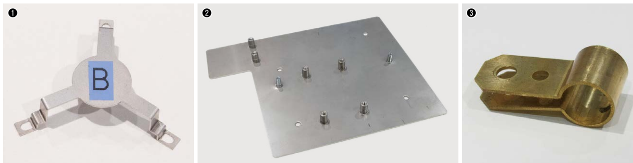
①板金加工だと12工程の曲げ加工が必要な製品を、一部プレス加工に工法転換することで2工程に削減した／②多数のカシメが必要な製品を、プレスカシメによって全体の工程を大幅に削減した／③ベンディングマシンだけでは加工が困難な形状を、プレス加工を利用することで安定加工を実現した
