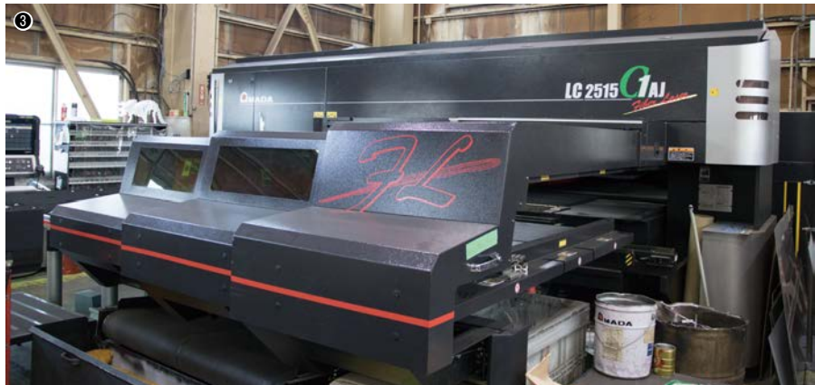
①工場屋根に設置した自家消費型の太陽光発電パネル(163枚・発電容量50kW) / ②③2020年9月に導入したファイバーレーザーマシンENSIS-3015 RIと、2019年3月に導入したファイバーレーザー複合マシンLC-2515 C 1 AJ。生産性向上と電力消費量の低減に貢献している
