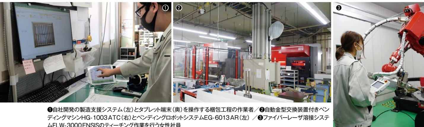
①自社開発の製造支援システム(左)とタブレット端末(奥)を操作する梱包工程の作業員／②自動金型交換装置付きベンディングマシンHG-1003ATC(右)とベンディングロボットシステムEG-6013AR(左)／③ファイバーレーザー溶接システムFLW-3000ENSISのティーチング作業を行う女性社員
