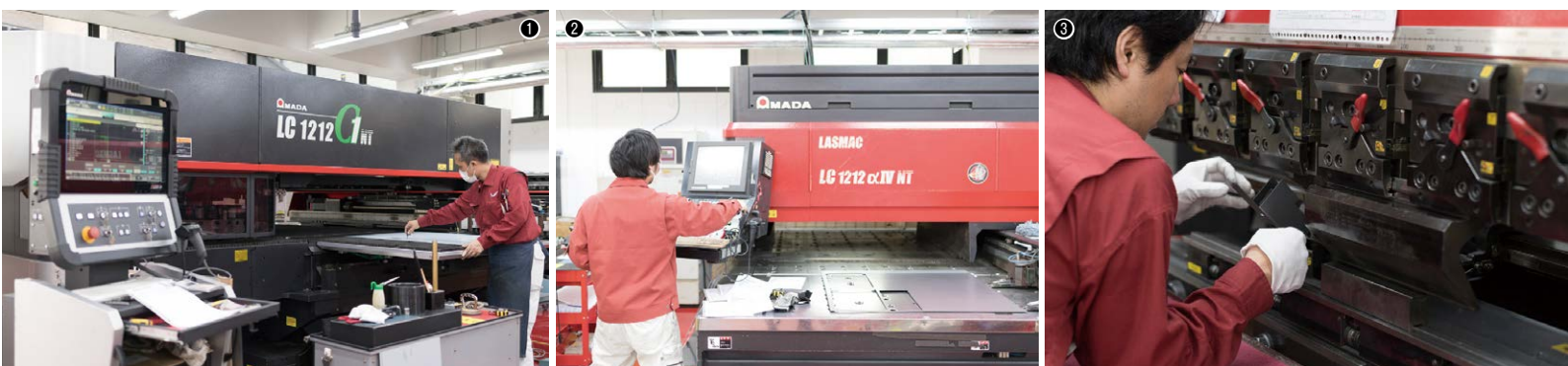
①板金工場の blanks 工程の主力、パンチ・レーザ複合マシンLC-1212C1NT / ②レーザマシンLC-1212αIVNT / ③曲げ加工。HG-8025、EG-6013、FBDⅢ-8020NTなどを設備している（撮影：香川賢志、3枚ずつ）
