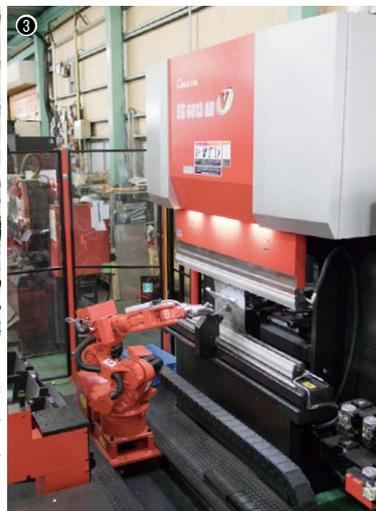
①本社工場のパンチ・レーザ複合マシンEML-3510NT(手前)とパンチングマシンEM-2510NT(奥)も長時間連続稼働に対応／②ベンディングロボットシステムHG-1303Rmも24時間稼働に対応する／③小物曲げに対応するベンディングロボットシステムEG-6013AR
