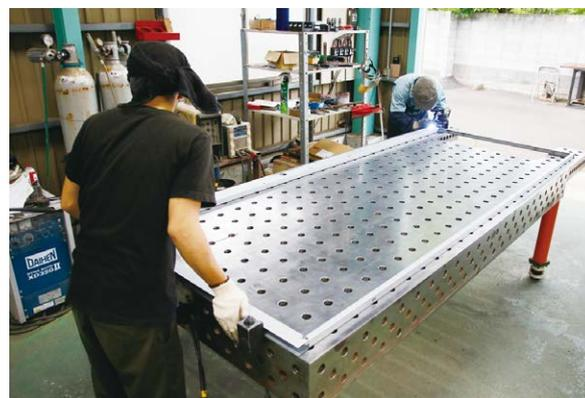
TIG溶接で間仕切り部品のフレームを組み立てる
