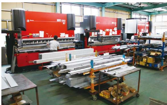
曲げ工程。事務用品メーカーから受注する間仕切り部品などの長尺製品が多い
