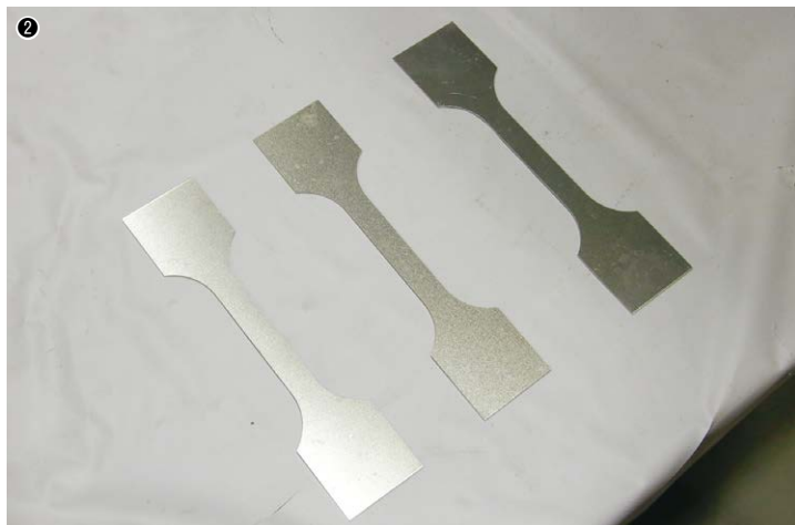
①高橋教授が行った実験のひとつ。ロードセルをサーボプレス本体や金型に取り付け、引張り試験や摺動試験を行う／②実験に使う試験片
